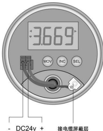
电子单元的面板布置及接线图
