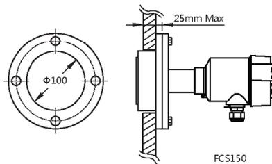
安装平板型时，要注意桶壁到固定法兰的厚度不能超过25mm，否则开关会出现误动作。
