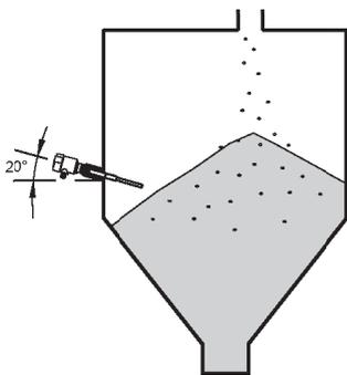
开关应向下与水平线保持 $20^\circ$ 为最好如此可增加开关的灵敏度，并减小下料时冲击造成开关受损。
