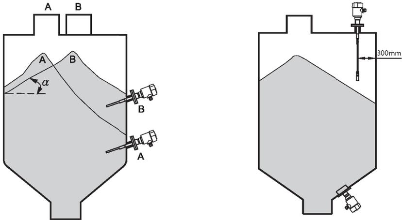
侧装时须注意安装位置，若入料口在非中心入料，就必须考虑安息角  $\alpha$  及入料口对应点安装，否则容易引起开关不动作。
