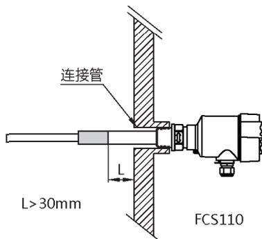
安装标准型，绝缘部分须伸入桶内30mm以上，避免连接管内有积料引起误动作及连接管与感应棒距离太近而无法调整灵敏度。
