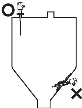
在原料流动较差时，使用开关上部安装方法可降低物料形成安息角对开关误动作的影响。
