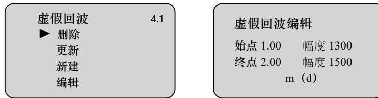
曲线编辑每次两点，始点和终点为欲编辑曲线位置坐标，其后对应的幅度数值就是需要修改的数值（注：当距离坐标输入或修改后，其后对应的幅度会自动根据当前保存的数据更新，用以作为幅度修改的参考）；两对坐标修改完成后，按 **OK** 键确认此次修改；仪表将根据输入的两个自动连成的直线生成新的虚假回波曲线，替代原曲线。
