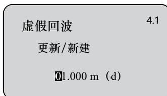
提示输入真实回波距离值，输入距离值后，按 **OK** 键确认，液晶显示请等待，仪表进行虚假回波的学习，完成后退到虚假回波学习菜单。
