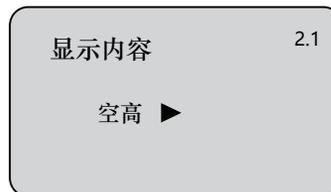
表示当前显示内容的参数是空高，即仪表显示测量的空高值。按 **OK** 键，进入编辑状态，液晶显示
